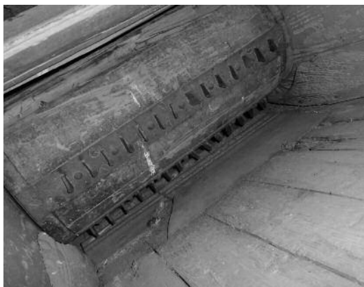
Bileta viser torvstrørivaren som tilhøyrer Vågå Historielag. Den er omgjort frå ein piggtruskar. Det kunne påkoplant motor-kraft, men det finst også sveiv til å dra rivaren manuelt. Det nedste biletet viser piggane innvendig.
